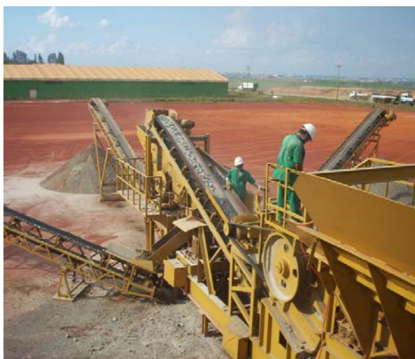
Vista parcial do sistema britador de RCC.
