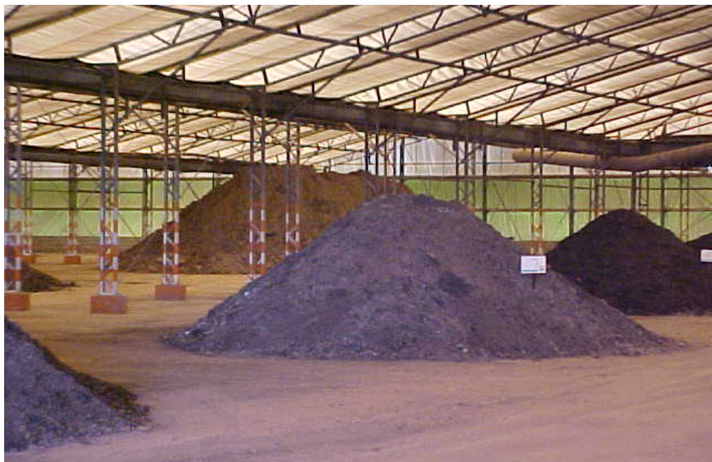
Interior de galpão da Unidade de Biorremediação do CGR-Paulínia. Pode ser observada a separação das pilhas e a respectiva identificação para o controle operacional do processo.
